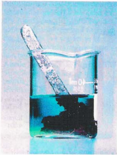
Abbildung 17.1 Wenn man einen Streifen Zink in ein Becherglas mit Kupfer(II)sulfat-Lösung taucht, scheidet sich Kupfer auf dem Zinkmetall ab, und die blauen Kupfer(II)-Ionen in der Lösung werden allmählich durch farblose Zink-Ionen ersetzt.
