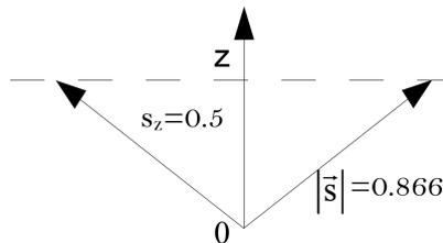
$s_z$  ist die Projektion von  $\vec{s}$  auf die z-Richtung. Wir errichten eine Senkrechte auf der z-Achse am Punkt 0.5 und ziehen einen Kreis um den Nullpunkt mit einem Radius von 3.464 cm, Schnittpunkte mit der Senkrechten auf der z-Achse sind Endpunkte des Vektors.
