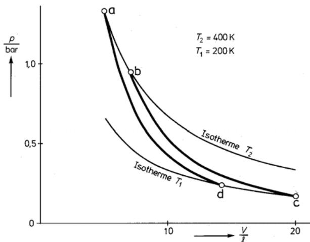
Korrekte Form der Isothermen (dünne Linien) und der Adiabaten (dicke Linien) eines Carnotschen Kreisprozesses
