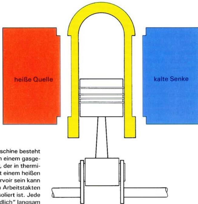
Die Carnotsche Maschine besteht aus einem Kolben in einem gasgefüllten Zylinder, der in thermischem Kontakt mit einem heißen oder kalten Reservoir sein kann und bei manchen Arbeitstakten auch thermisch isoliert ist. Jede Phase läuft „unendlich“ langsam ab, so daß die erzeugte Arbeit maximal wird — und keine Verluste durch Turbulenz, Reibung oder Ähnliches auftreten.
