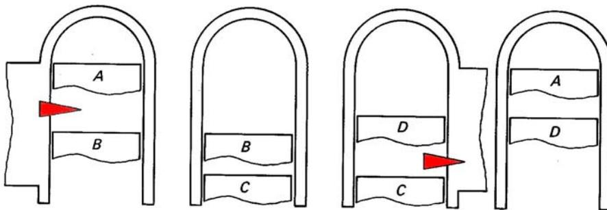
Die Arbeitsschritte des Carnotschen Kreisprozesses für die oben gezeigte Maschine. Der rote Pfeil symbolisiert den Wärmefluss
